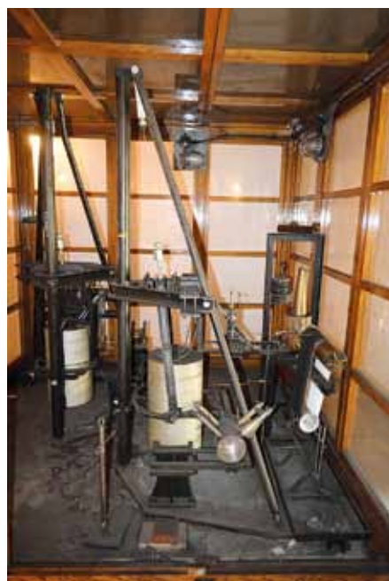
NAJSTARŠÍ FUNKUJÚCI PRÍSTROJ V SAV JE SEIZMOGRAF MAINKA ZO ZAČIATKU 20. STOR.
